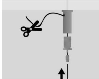
5. Installare la staffa del rosone al soffitto in corrispondenza del foro di alimentazione già realizzato.
