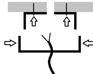
6. Far passare il cavo di alimentazione all'interno del foro del rosone ed effettuare le connessioni ai morsetti e all'alimentatore.
